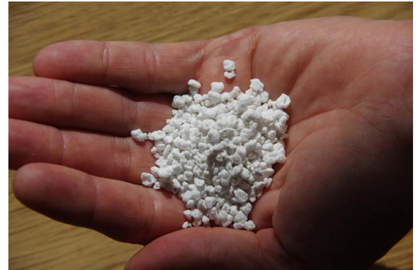
Perlite, isolermaterial av vulkaniskt ursprung (hydrofoberat för fuktsäkerhet). Ängmogruppen
