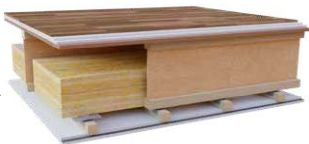
En typisk lägenhetsskiljande bjälklagskonstruktion med brandklass REI60.
