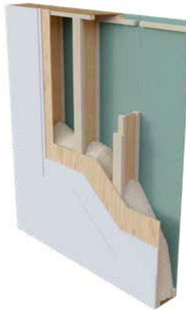
Bärande yttervägg för, i huvudsak, hus upp till åtta våningar med Termoträ träfiberisolering som klarar brandklass REI120.
