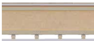
Vertikalsnitt lägenhetsskiljande bjälklagskonstruktion med brandklass REI60.
