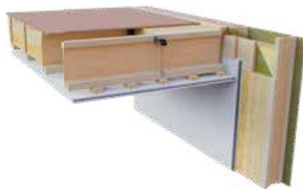
Vertikalsnitt lägenhetsskiljande bjälklagskonstruktion med brandklass REI60.
