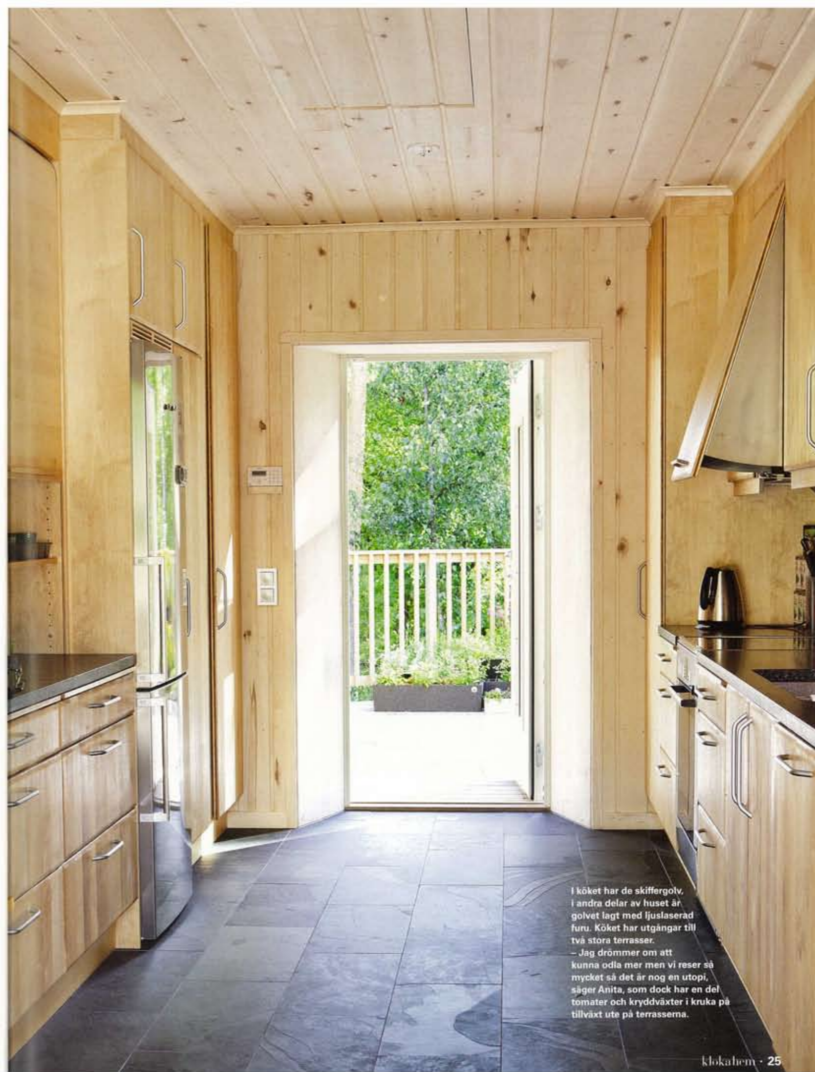
Köksbänken är av granit och den fasta köksinredningen är gjord av hårdvaxolja björk. I köket sitter en volymkåpa som med självdrag ventilerar bort matoset när man öppnar spjället, det är värmen från matlagningen som skapar självdraget. Systemet har valts för att få det bästa och tystaste inomhusklimatet – men på köpet slipper man en bullrande fläkt som drar el.
